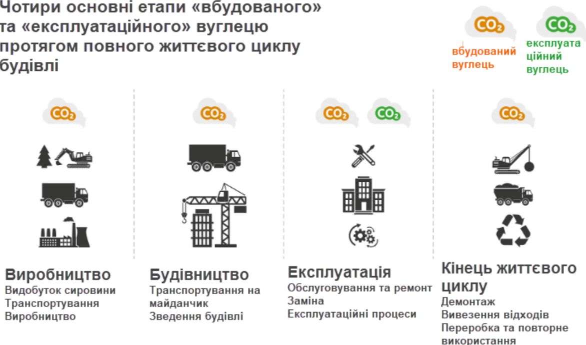
Рис.1 Чотири основні етапи «вбудованого» та «експлуатаційного» вуглецю протягом повного життєвого циклу будівлі
