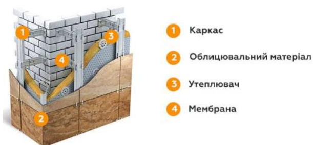
Рисунок 1. Схема навісного вентилязованого фасаду та схема його функціонування
